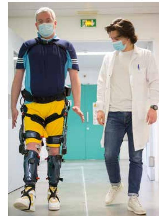
exosquelettes (le Keeogo+ et le MyoSuit) lors de la marche, du relevé de chaise et de la posture debout. En parallèle, l'équipe évalue le coût énergétique de la marche, avec ou sans exosquelette. Les analyses préliminaires montrent une réduction de ce coût à mesure que l'intensité augmente avec l'exosquelette versus sans cette assistance.
